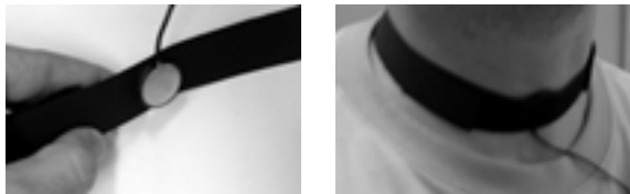
Fig. 2: Disco piezoelétrico fixado ao colar de velcro e colocação do colar na base do pescoço.
