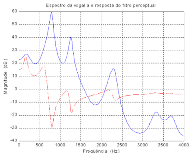
Fig. 31 O espectro da vogal “a” e a resposta em freqüência do filtro de pesagem de erro correspondente com \alpha=0.8 .
