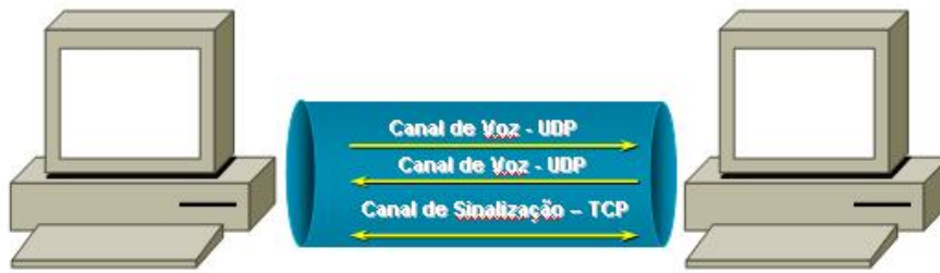
Figura 5.1 – Funcionamento do sistema, um canal para sinalização e dois canais para voz.
