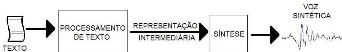
Figura 2.1: Diagrama de blocos básico de um sistema TTS.
