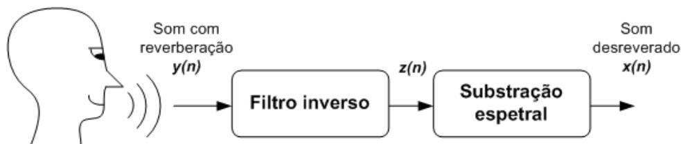
Figura 4.1: Diagrama de blocos do algoritmo de desreverberação de Wu-Wang.
