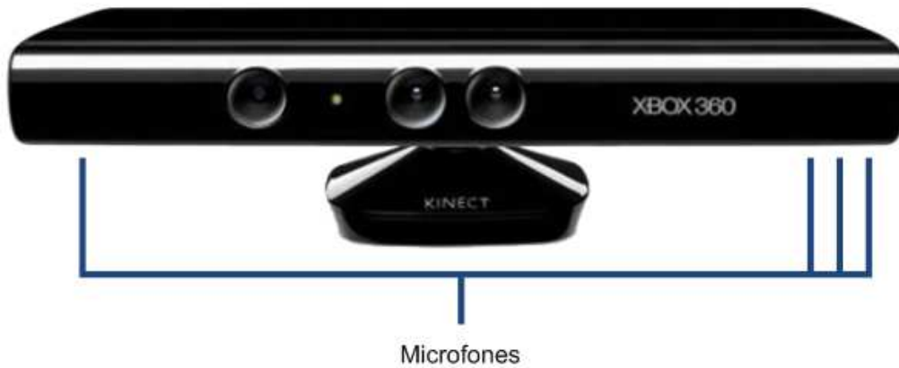
Figura 2.6: Localização dos microfones no dispositivo Kinect.
