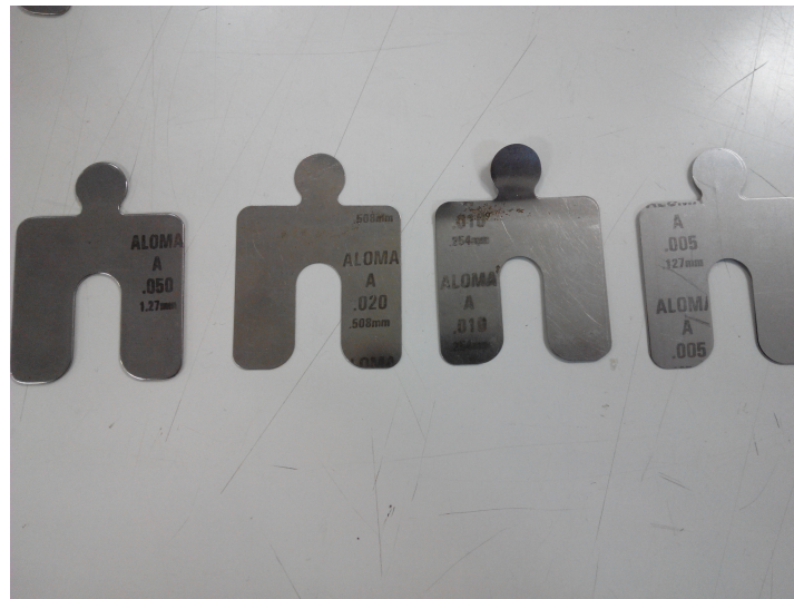
Figura 3.20: Calços empregados para o desalinhamento paralelo vertical.
