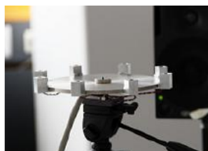
Figura 5.1: Microfones utilizados para medir as RIRs no contexto do REVERB Challenge. Fonte [17].
