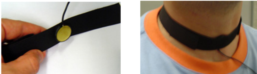
Figura 4.4-2: (a) Disco piezoelétrico fixado ao colar de velcro; (b) colocação do colar na base do pescoço.
