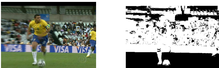
Figura 3.8: Quadro de vídeo original e máscara binária para exemplo 4. O algoritmo mostra-se capaz de determinar quais os pixels de uma imagem são do campo, mesmo quando o percentual destes na imagem é reduzido.
