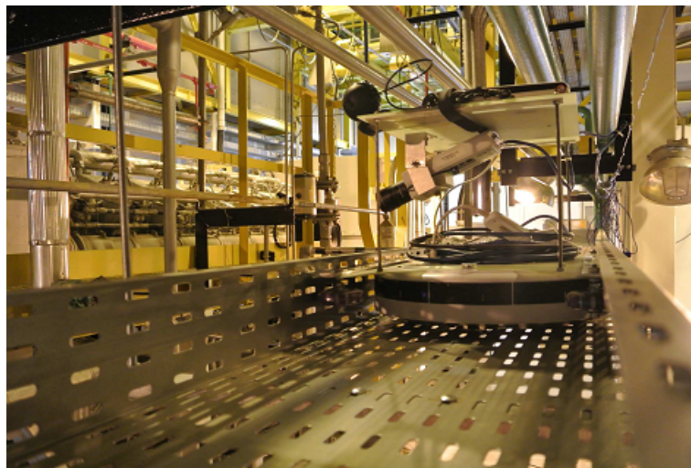
Figura 5.4: Sistema para monitoramento de um ambiente industrial com uma câmera montada em uma plataforma robótica.
